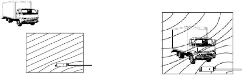
Slika 2: Feromagnetni objekt s svojo prisotnostjo spremeni zemeljsko magnetno polje
