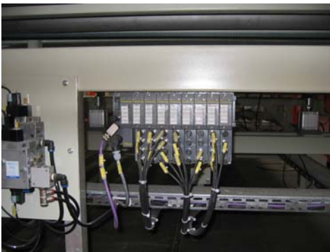
Slika 6: BL67 vgrajen direktno na transportno linijo
